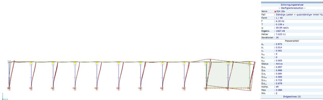
Bild 92 Freibadgarderobe: 1. Eigenform in x-Richtung. T_1 = 0.159 s, f_1 = 6.30 Hz, \epsilon_y = 97.2\%
