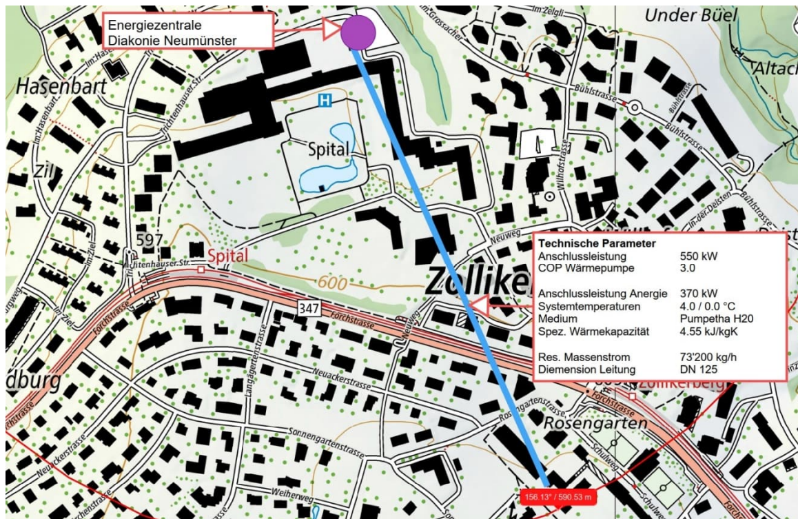
Bild 3: Übersicht Anschluss Anergie
